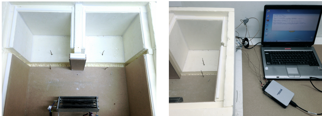
Photos montrant le montage de la boîte hermétique et des sondes
