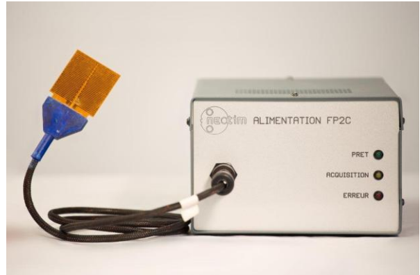
Figure 26 : Sonde FP2C Appareil de mesure de la conductivité thermique par la méthode du fil chaud.
