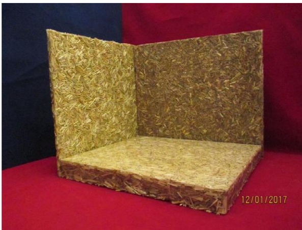
Figure 10 22 : Panneaux en paille de riz destiné à la construction d'habitat et de meuble
