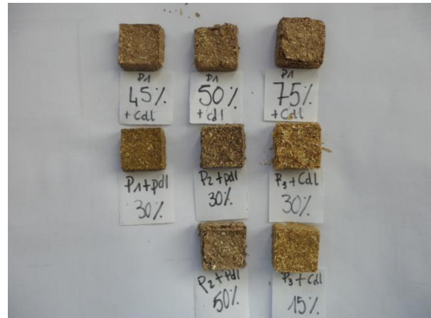
Figure 23: Ensemble des échantillons ayant la colle de lait pour liant.
