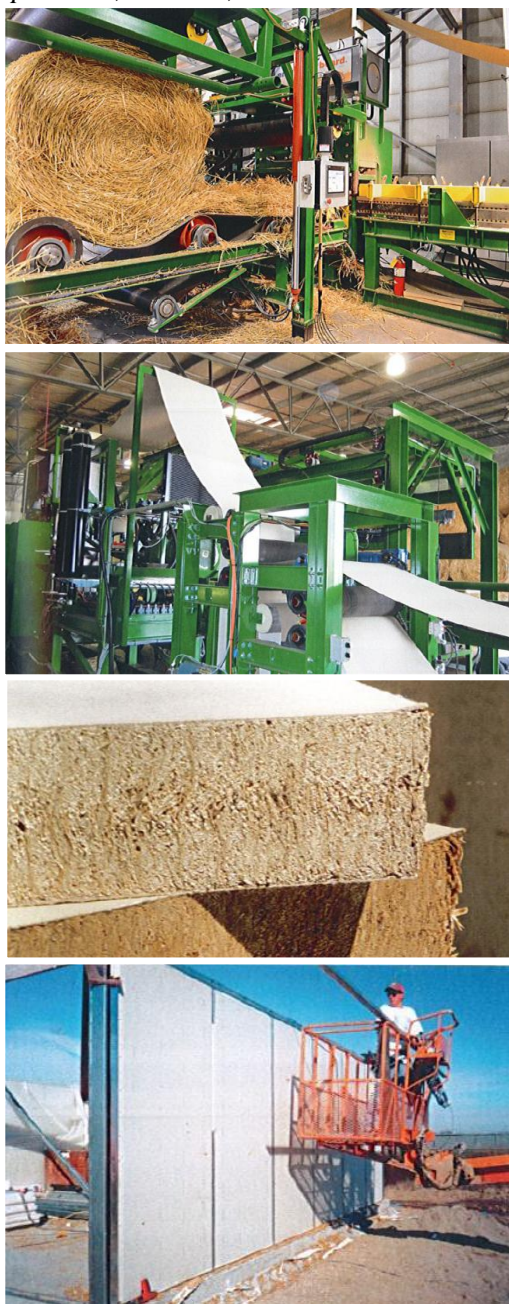
Figure 7 16 : Déroulage des balles de paille, pellicule recouvrant le panneau, panneaux de paille, installations des panneaux en paroi dans une structure métallique
