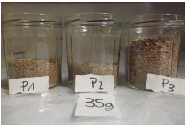
Figure 16: Différence de densité : d(P1)=0.46g/cm^3 , d(P2)=0.54g/cm^3 , d(P3)=0.23g/cm^3 .
