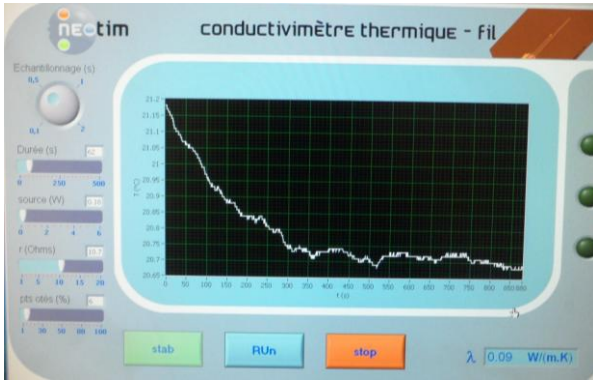
Figure 28 : Stabilisation de la température du dispositif pour l'échantillon P1(35)-Eau.
